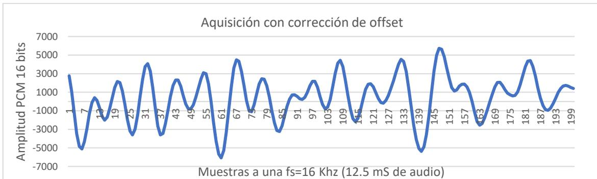
Ilustración 21.- Señal aplicando la corrección de offset (elaboración propia).
