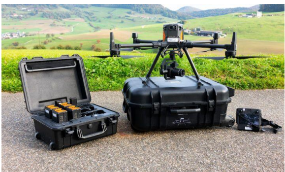
Figura 3. Dron multirrotor - DJI Matrice 300, tiene los rotores de manera horizontal (Fuente: Wingtra, 2021).
