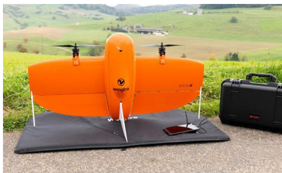
Figura 4. Dron de ala fija - WingtraOne GEN II, tiene al menos un rotor colocado de manera vertical (Fuente: Wingtra, 2021).
