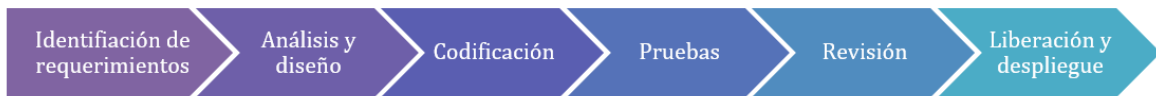
Figura 9. Elaboración propia con base en la metodología cascada tradicional de creación de un software.
