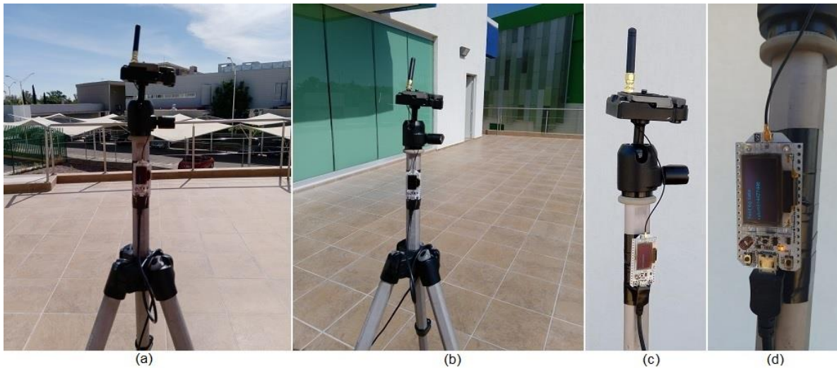
Figura 20. Imágenes del nodo final. (a) Vista general del nodo montado en el tripié. (b) Otra localidad de medición. (c) Detalle del montaje del nodo en el tripié, (d) Detalle para observar información del envío de un mensaje.
