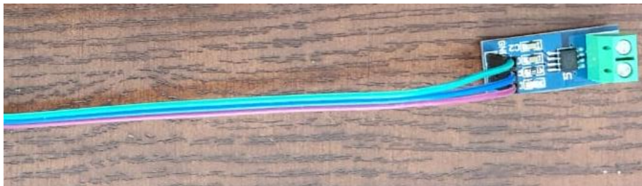
Figura 43 Tarjeta Breakout de sensor ACS712. Fuente:Elaboración propia.
