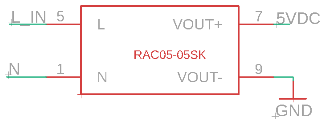
Figura 25 Conector de fuente de voltaje AC/DC en esquemático. Fuente:Elaboración propia.
