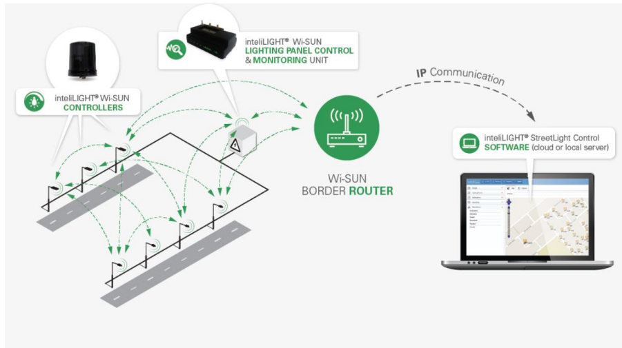
Figura 2 Arquitectura del sistema IntelliLIGHT WiSun. Fuente: Página de internet de Intelilight.
