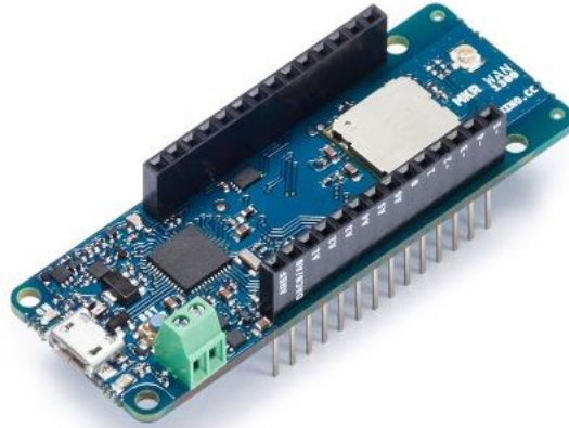
Figura 7 Tarjeta Arduino MKR WAN 1300. Fuente:Página de internet de Arduino.
