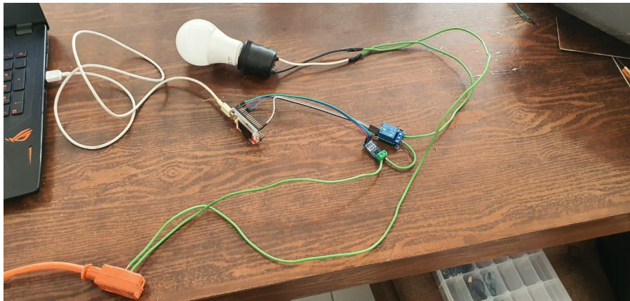
Figura 47 Modulo relevador activado. Fuente:Elaboración propia.
