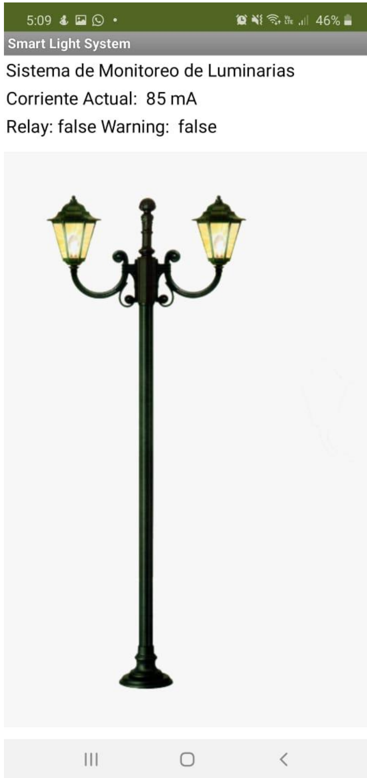
Figura 57 Aplicación de lectura de corriente. Fuente:Elaboración propia.
