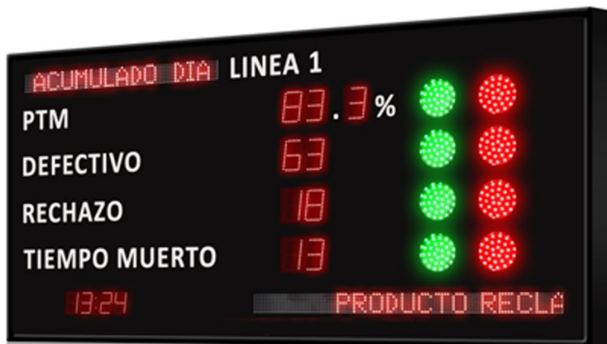
Figura 9 Ejemplo de tablero de led tradicional con indicadores de estado Andon. Tomada de “ ANDON System [fotografía], Itek, 2020, http://www.itek.mx/language/andon-system.html [11].
