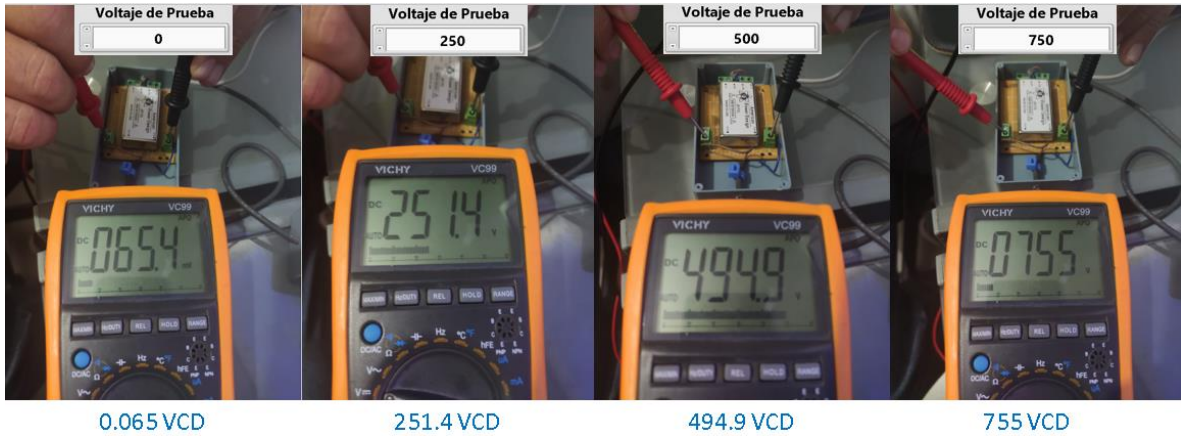
Figura 34. Prueba de salida de voltaje en el convertidor DC-DC.
