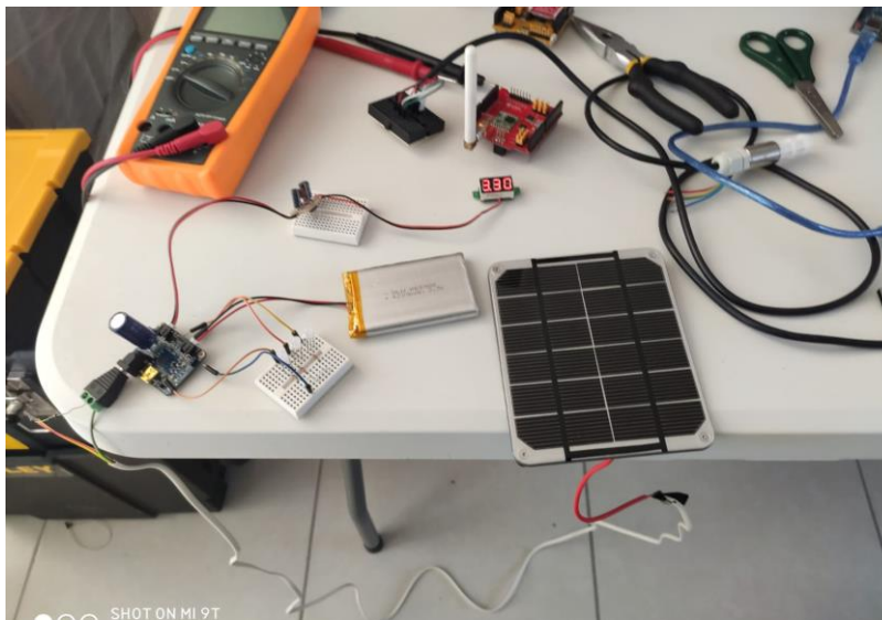
Figura 31: Prototipo funcional de la energía del sistema embebido. Fuente: Elaboración propia.
