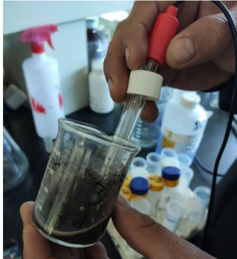
Figura 8: Medición de suelo ácido con sensor Atlas Scientific. Fuente: Elaboración propia.
