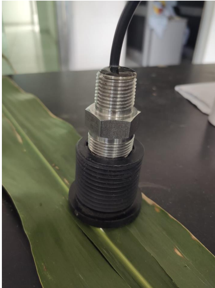
Figura 61: Medición de índice de clorofila en hoja de maíz. Fuente: Elaboración propia.
