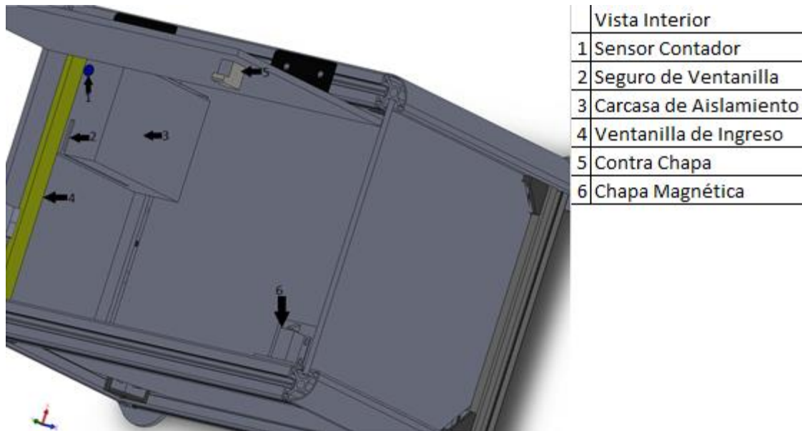
Figura 6 Vista interior Vista inferior del contenedor de tarjetas PCB no conformes FUENTE: Elaboración Propia.
