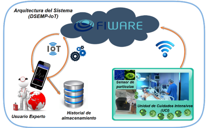
Fig. 1. Arquitectura del sistema embebido para el monitoreo de partículas de polvo basado en el Internet de las Cosas.
