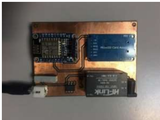
Figura 15. Imagen del hardware terminado, del Sistema domótico de monitoreo energético no intrusivo Fuente: Fuente propia a partir del diseño propuesto
