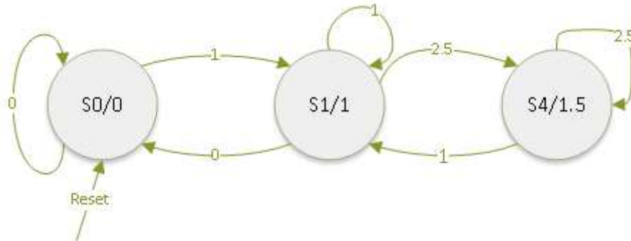
Figura 21. Ejemplos de una máquina de estados para detección de variaciones en la corriente I_{rms} . Fuente: Fuente propia a partir de una máquina de estados genérica
