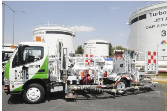
Fig. 18. Vehículo autotankue y vehículo dispensador de combustible de aviación.
