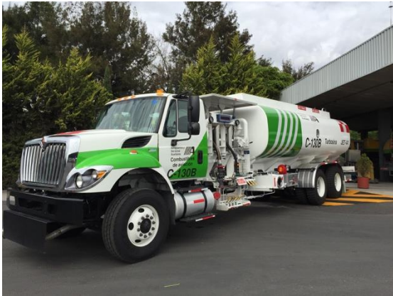
Fig. 18. Vehículo autotankue y vehículo dispensador de combustible de aviación.
