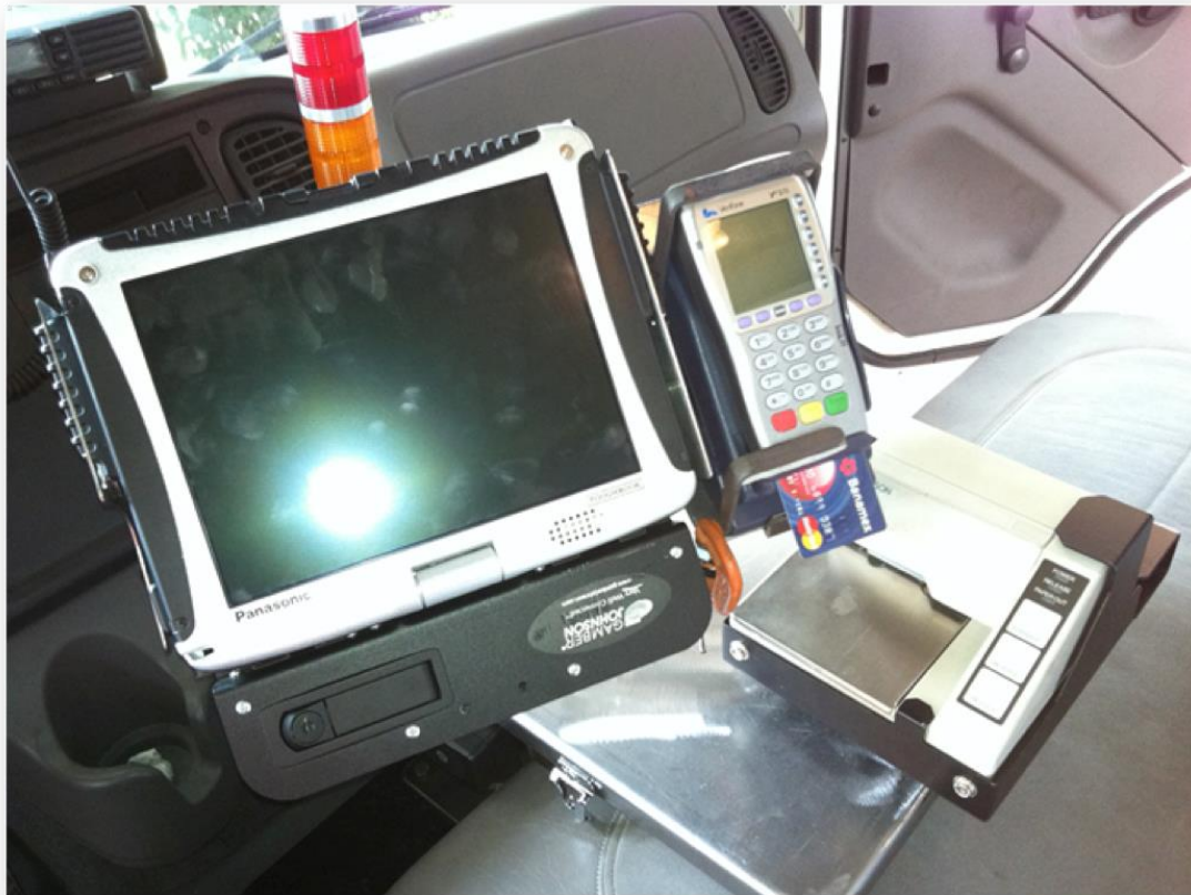
Fig 19. Equipo de cómputo, terminal punto de venta e impresora del Sistema de Control de Combustibles en Plataforma SCCP.
