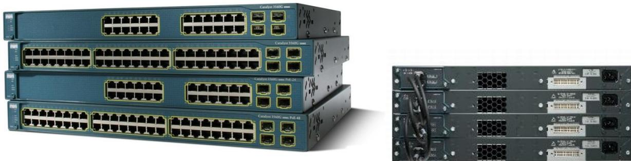
*“Una pila de switches es un conjunto de hasta nueve switches apilables con capacidad conectados a través de sus puertos StackWise Plus o StackWise. Puede conectar sólo un tipo de interruptor en una pila, o se puede conectar una combinación de Catalyst 3750-X, Catalyst 3750-E y Catalyst 3750 switches de la pila. Catalyst 3750-X y Catalyst miembros de la pila 3750-E han StackWise puertos Plus y Catalyst 3750 miembros han StackWise puertos.”<sup>13</sup>*
